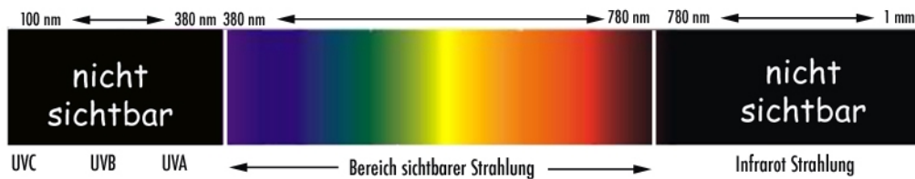
Bild 2 Aufteilung der optischen Strahlung in Bereiche. Die nicht sichtbaren Strahlungen können von Lichtquellen herrühren, haben physiologische Wirkungen, rufen aber keine Sehempfindung hervor.
