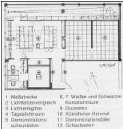
Bild A.87 Lichtlabor als Testeinrichtung /A.49/
