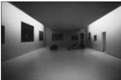
c) Die über den Längswänden angeordneten Oberlichtschächte erhalten Licht von der nicht einsehbaren Innenseite. Die Wände werden primär, aber ungleichmäßig, nach unten stark abfallend beleuchtet. Die Raummitte und die Deckenuntersicht wirken düster. Der Raumeindruck erscheint dramatisiert. Die Adaptation an die Raumhülle ist durch die Übersteigerung der Kontraste gestört.
